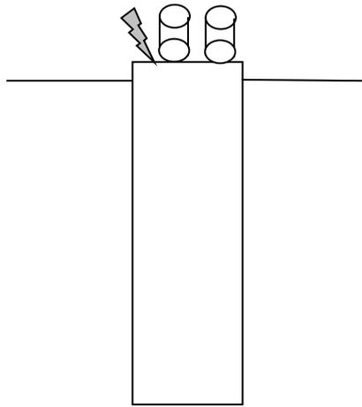
Рис. 5.2.4. Схема расположения источника и сейсмоприемников на оголовке сваи
