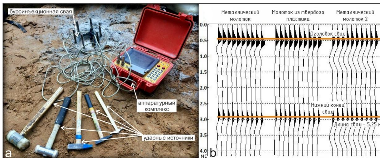
Рис. 5.2.3 Оборудование и пример полевых результатов сейсмоакустического исследования свай.
