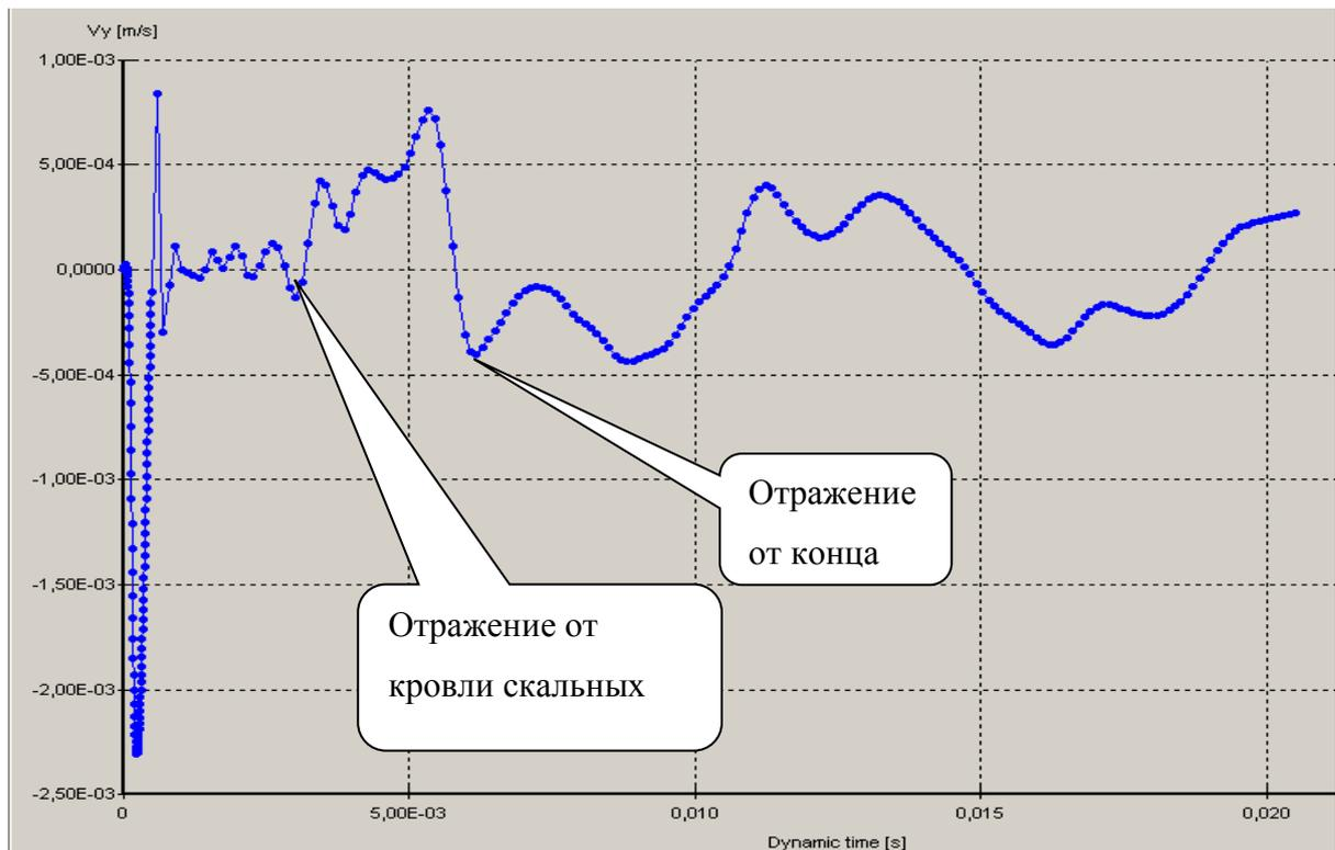
Рис. 5.2.6 Трасса акустических колебаний на поверхности сваи рассчитанная методом конечных элементов. (Длина сваи 10.0 м, диаметр 1.0 м, скорость в бетоне 4300 м/сек, свая заглублена на 4.0 м в скальные породы).
