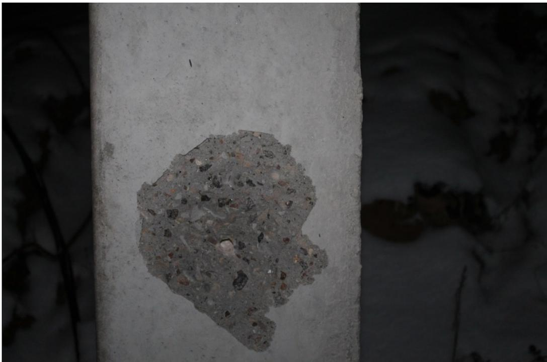
П.7.2. Испытание свай методом отрыва со скалыванием
