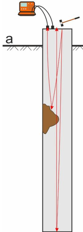
Рис. 5.2.2. Сейсмоакустический метод контроля сплошности и длины свай (SIT)
