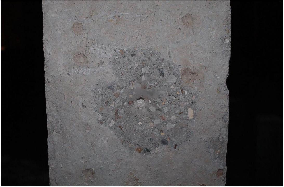
П.7.3. Испытание свай методом отрыва со скалыванием
