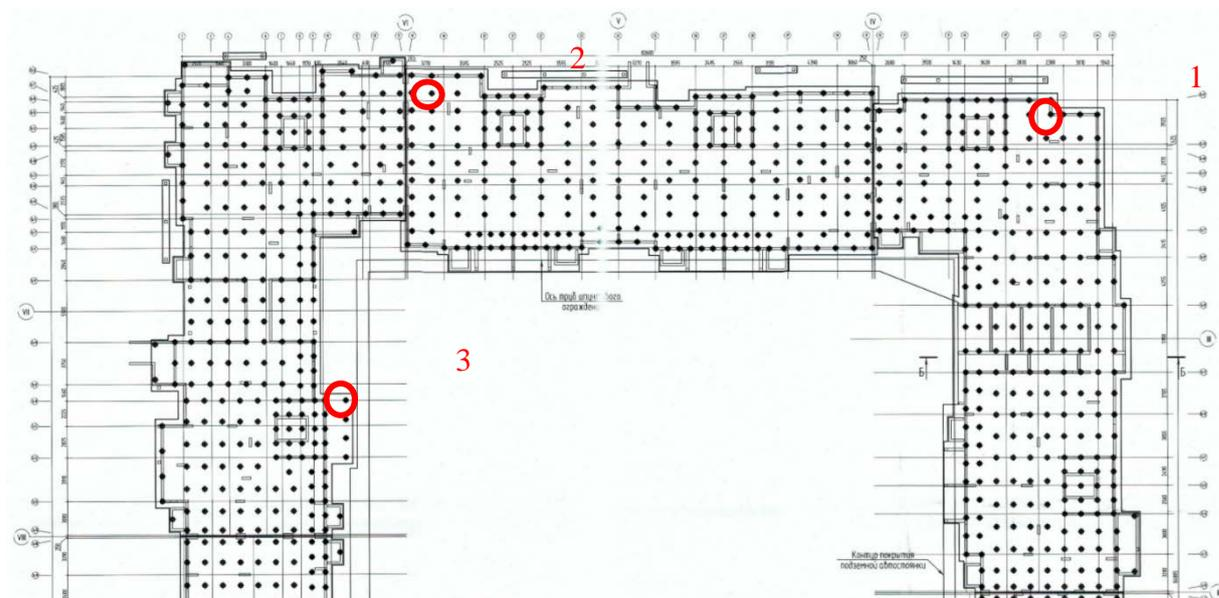
Рис 5.2.1. Схема расположения испытанных свай.
