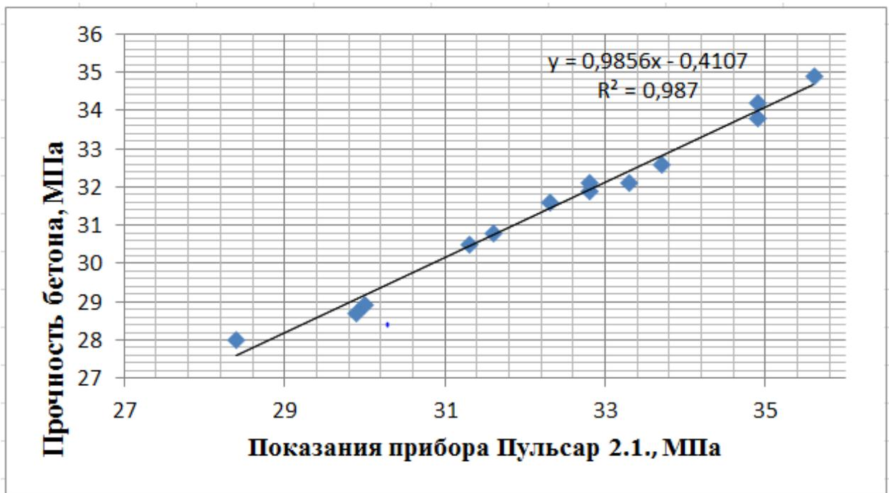
Рис.5.7.1 Градуировочная зависимость прочности бетона от скорости продольной волны
