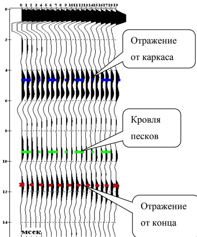
Рис. 5.2.5. Вид полного ансамбля сейсмоакустических трасс на свае.
