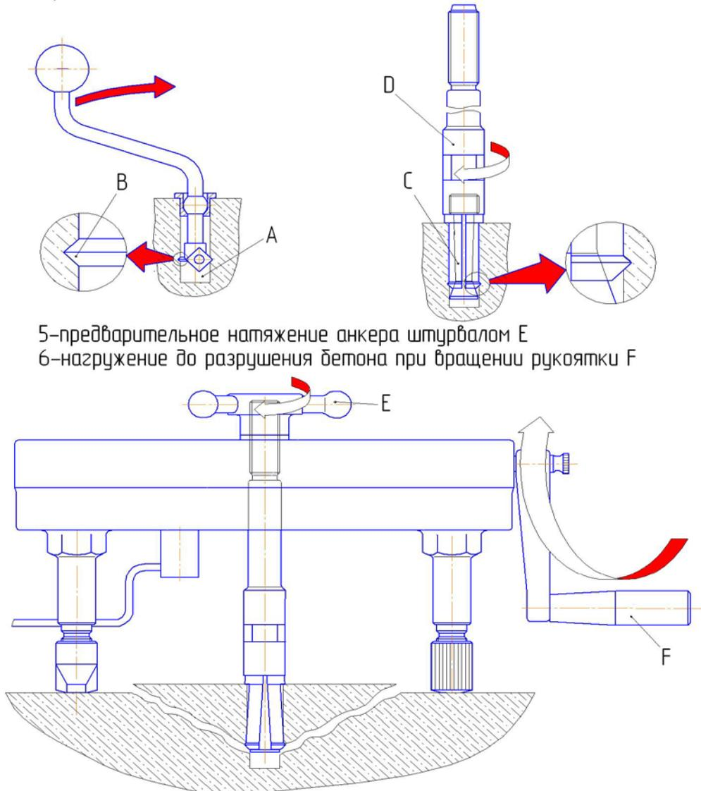
Рис. 5.5.1. Порядок проведения испытаний.
